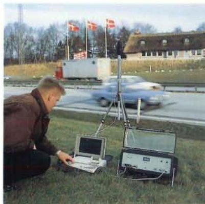
L'analizzatore di livello sonoro 4435 e l'unità microfonica per esterni 4184 sono parte del sistema portatile di monitoraggio del rumore
