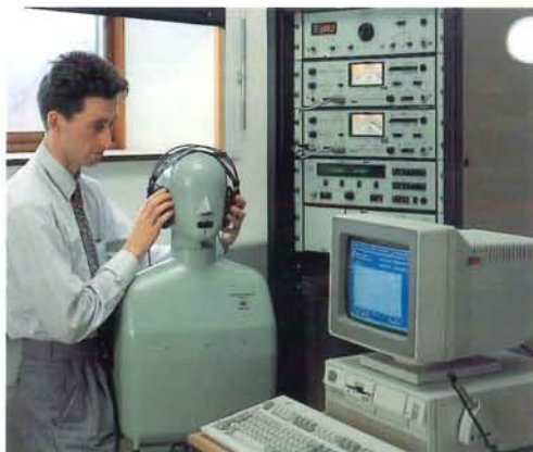
I sistemi di verifica elettroacustica sono sistemi completi di verifica R & D e QC, per le misure sui trasduttori elettroacustici di comunicazione e su altri dispositivi
