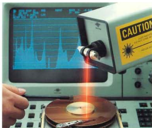
Il set trasduttore laser 3544, che consiste nel trasduttore laser di velocità 8323 e l'alimentatore 2815, permette di misurare la vibrazione senza alcun contatto
