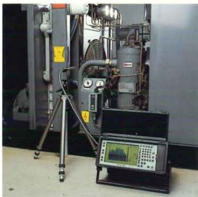
L'analizzatore in tempo reale 2143 permette di effettuare misure del suono e delle vibrazioni, in ogni tipo di ambiente
