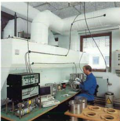
Un sistema di gas tracciante, controllato da un software applicativo funzionante tramite un computer portatile, permette di misurare l'efficienza delle cappe aspiranti
