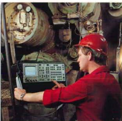
L'analizzatore portatile di vibrazione 2515 effettua la diagnosi delle condizioni dei macchinari sul posto e permette dei monitoraggi sistematici
